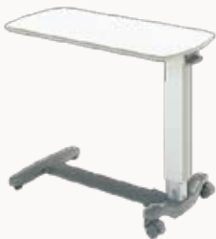
ベッドサイドテーブル KF-192 ガススプリング調節式 天板:メラミン樹脂化粧板 寸法:幅80.7×奥行42×高さ63.5~92.5cm 利用者月額負担・・・¥400
